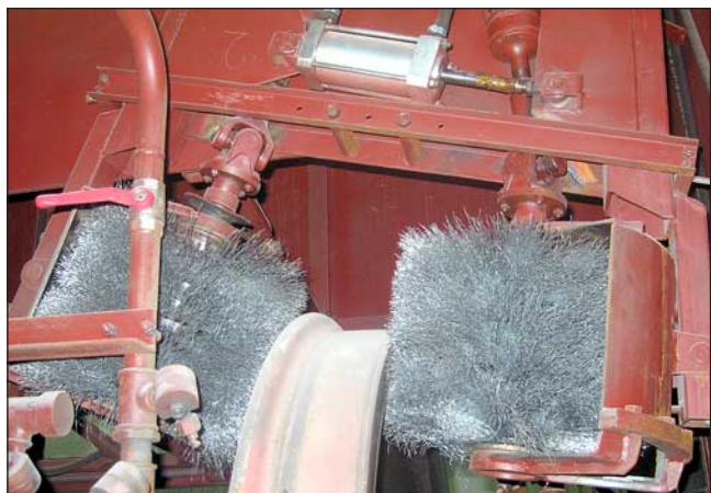
Рис. 5. Пара верхних щеток в поднятом и разведенном состоянии с пневмоцилиндром, обеспечивающим прижим щеток к диску
