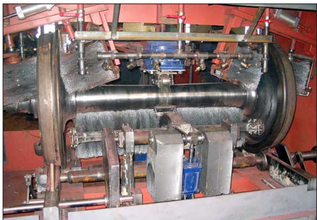
Рис. 6. Очистка оси и дисков вращающимися щетками. Узел верхних щеток позиционирован относительно оси, верхние щетки прижаты к диску, нижние — к оси
