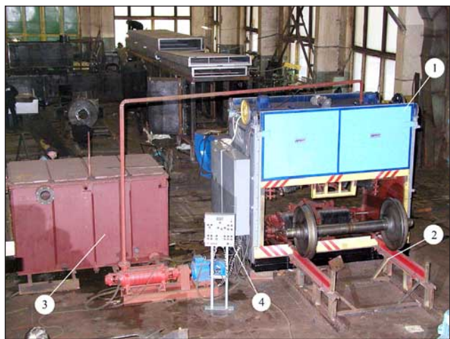
Рис. 1. Испытания комплекса на заводе-изготовителе: 1 — камера мойки колесных пар; 2 — устройства подачи колесной пары; 3 — система подготовки моющего раствора; 4 — система автоматического управления
