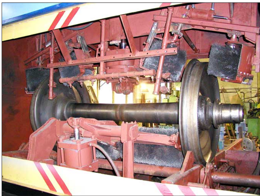
Рис. 3. Момент подачи колесной пары в камеру мойки. Верхние щетки подняты и разведены, нижняя опущена
