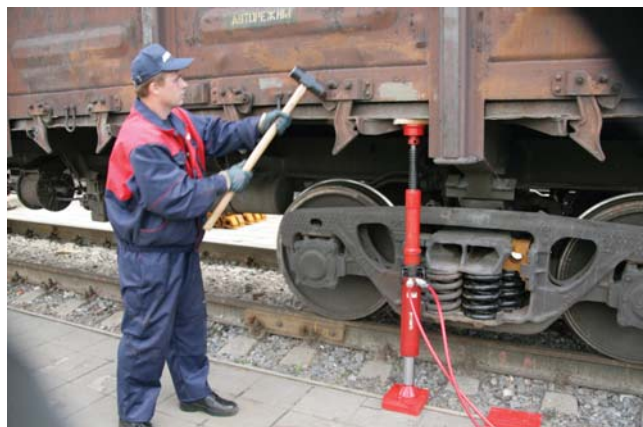
Поджатие и правка крышек люков полувагона
