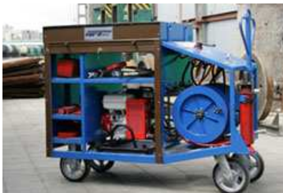
Транспортное средство с гидростанцией и набором гидроинструмента.
