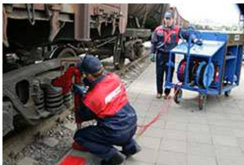
Операция замены пружинного комплекта.
